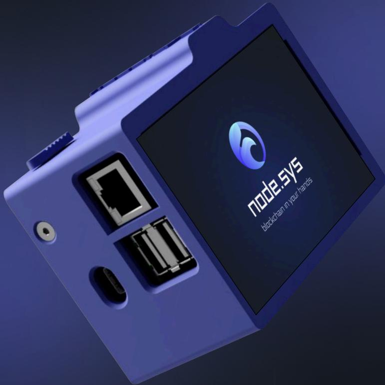
Основным элементом **Node.sys** является аппаратная системообразующая нода, которая представляет собой готовое аппаратное решение на базе общедоступных компонентов, с возможностью самостоятельной сборки и печати корпуса устройства на 3D-принтере. Функционал аппаратной ноды заключается в обработке транзакций децентрализованной сети, генерировании блоков и поддержке таким образом сети блокчейн.
